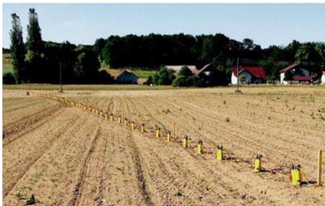
Figuur 2 - Een lijnopstelling van gefoons
