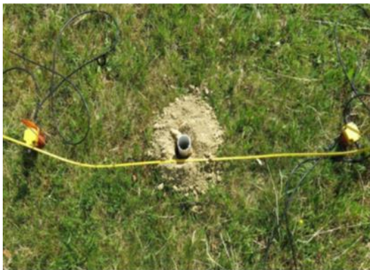
Figuur 4 - Klein gat voor gecontroleerde ontploffing
