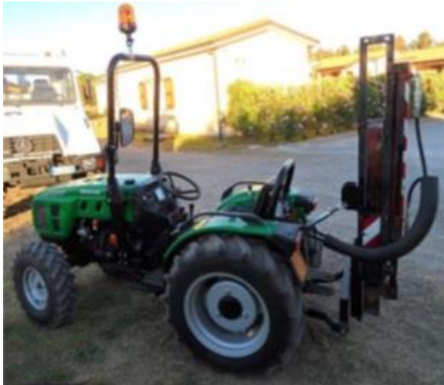
Figuur 6 - Trekker met valinstallatie (hamer)
